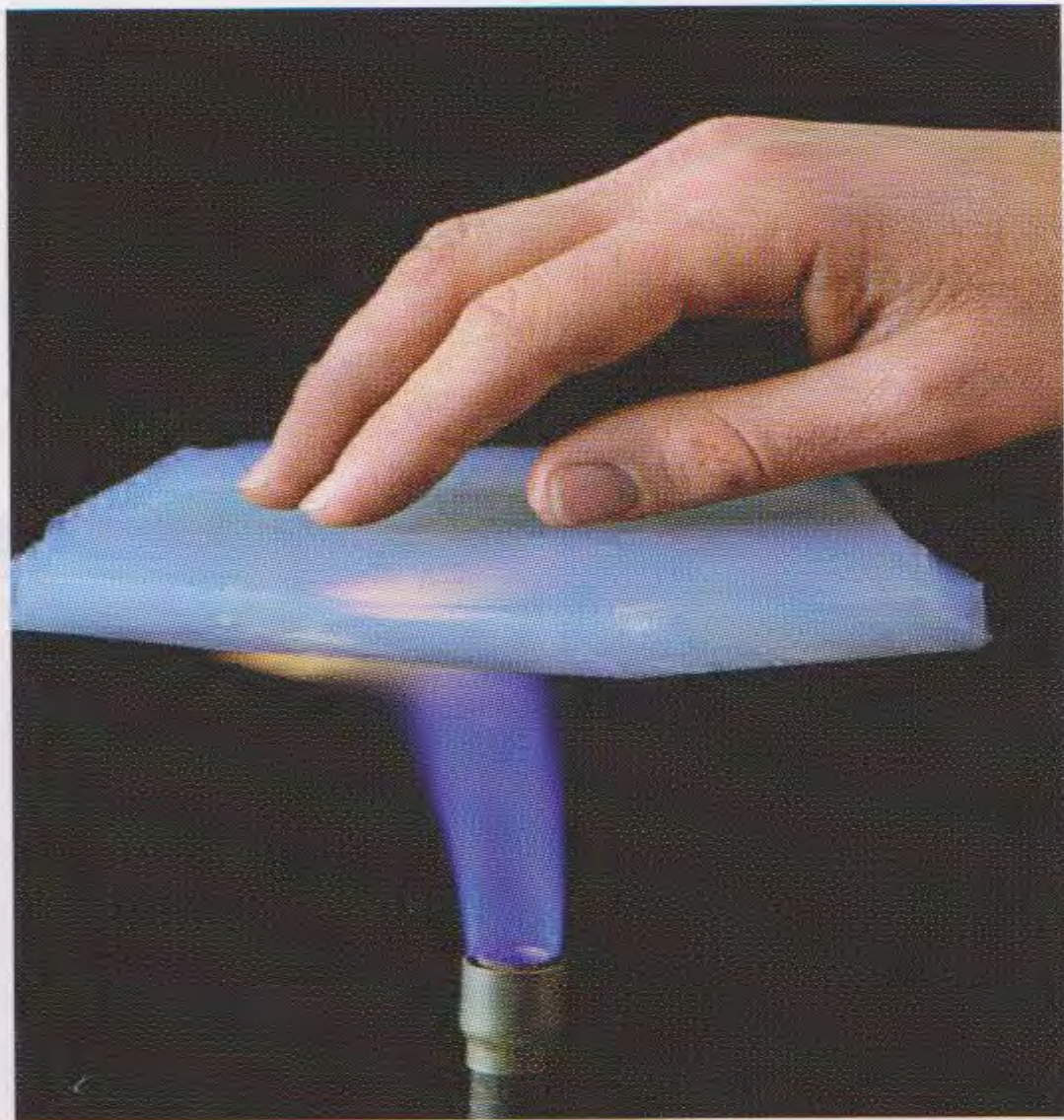
図 5.7 軽く、断熱性の高いシリカエアロゲル。バーナーの炎で飛ばされないように手で押さえている。
